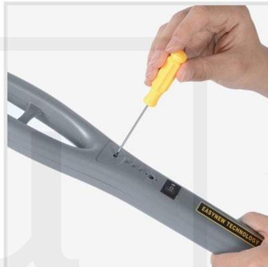
**Korak 2.** Koristite mali ravni odvijač (ne isporučuje se uz uređaj) i okrećite suprotno od smera kazaljke na satu dok ne čujete zvuk.
