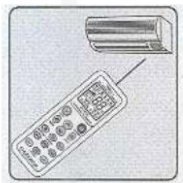
2. Pritisnite dugme koje odgovara brendu klima uređaja koji koristite i držite dugme pritisnuto dok uređaj ne odgovori tako što će se čuti zvučni signal. Zatim otpustite dugme i podešavanje je završeno.
