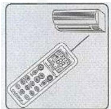
2. Držite pritisnuto dugme SET (oko 6 sekundi) dok se na ekranu upravljača kod za tip klima uređaja ne promeni, što ukazuje na to da ste započeli pretragu tipa klime uređaja velike brzine, pritisnite OK dugme da biste zaustavili pretragu sve dok klima uređaj automatski ne započen sa radom.
